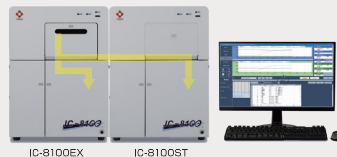
2システムインジェクションモードにおけるシステム制御
